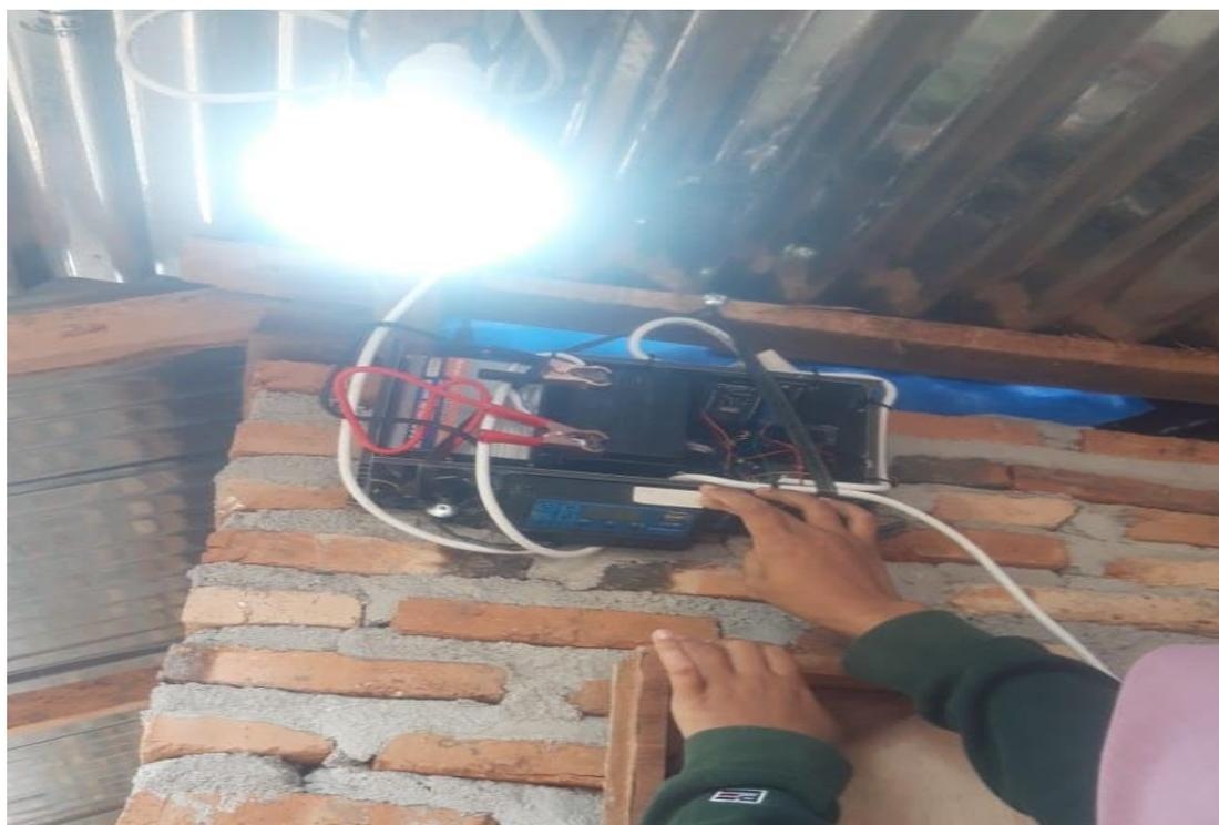
Gambar 7. Pengujian Beban Lampu Menggunakan Panel Surya
