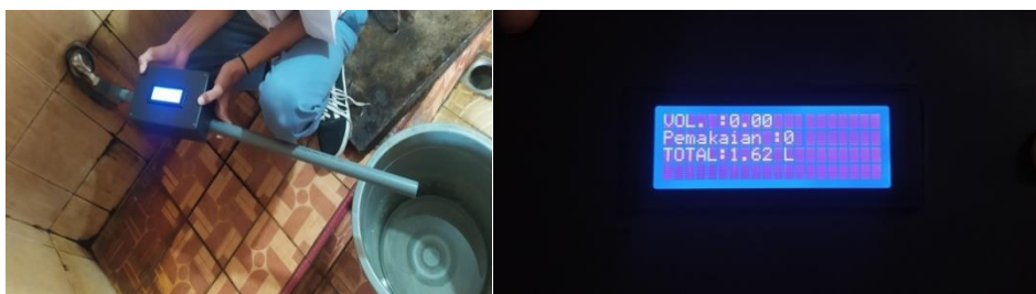
Gambar 8. Hasil Pengujian Alat Meteran Air Digital Menggunakan Sistem IoT
