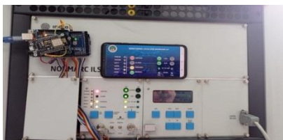
Gambar 9. Hasil Pengujian Monitoring ILS pada Saat Kondisi Tx1 Sedang aktif Melayani
