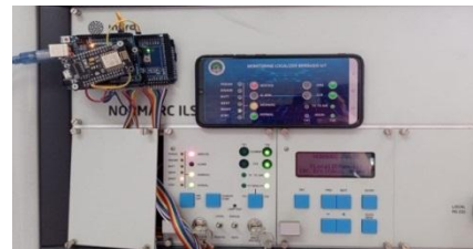
Gambar 10. Hasil Pengujian Monitoring ILS pada saat Kondisi Tx2 Sedang Aktif Melayani
