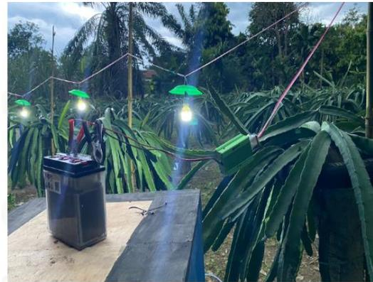
Gambar 3. Pengujian inverter input 12VDC menjadi 220VAC beban 75 Watt
