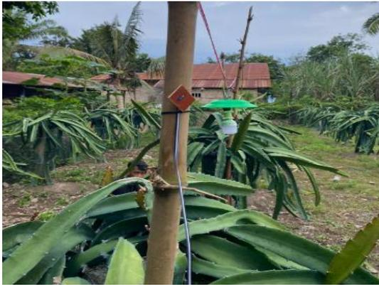
Gambar 2. Tampilan Pemasangan Sensor DS18b20
