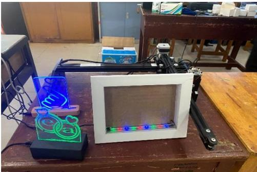
Gambar 3. Hasil Desain Akrilik Menggunakan Mesin CNC
